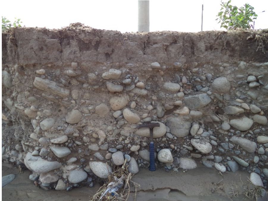
Figura 26. Terraza fluvial de la margen derecha del río Chillón. La clasificación del suelo es: Limo con un poco de arcilla, de color marrón, con nula plasticidad, consistencia blanda, humedad baja, presencia de raíces (prof.: 0.00-0.20m) y Grava arenosa, con partículas de forma redondeada y sub-redondeada, color gris clara, de baja compactación, humedad baja (prof.: 0.20-1.00m).
